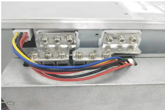
将电源 6pin 插头按下图方式插入机器的 6pin 插座内。
